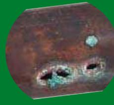
**Picaduras:** La corrosión por picaduras constituye un tipo de daño grave debido a la rapidez con la que se puede provocar la perforación en la sección metálica afectada.
